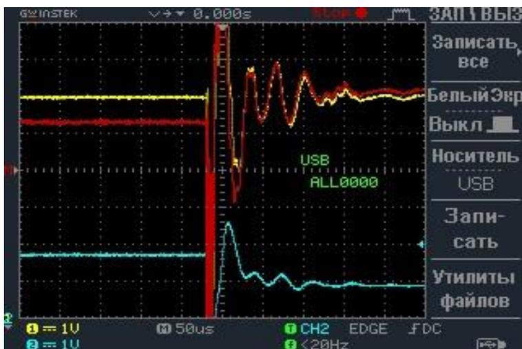
*Рис. 4. Осциллограмма однофазного замыкания фазы А на землю на участке 1 модели линии электропередачи*
